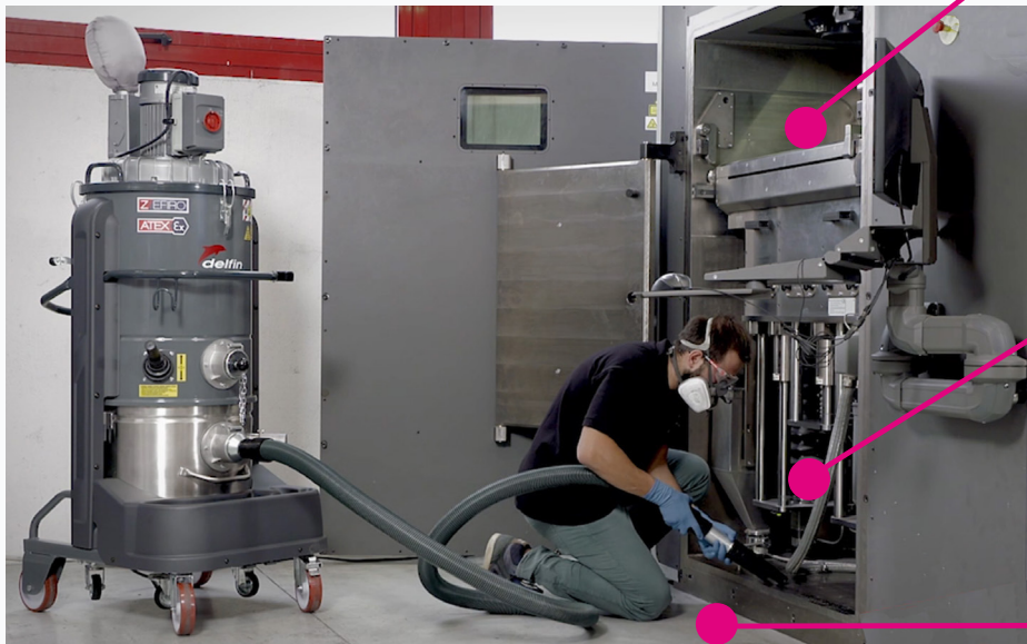
Svuotamento camera Empty the build chamber
